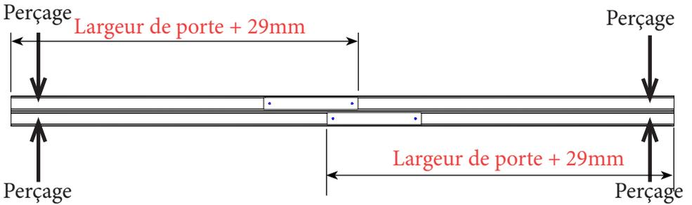
Percez et traversez le rail haut et les supports d'amortisseurs à l'aide d'une mèche de diamètre 5.
