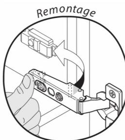
Mettre la charnière dans les encoches de l'embase, appuyer pour clipser
