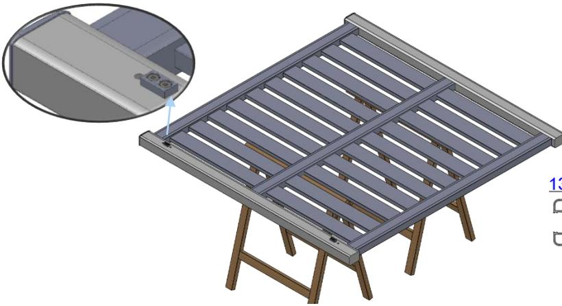
**Etape 2 :** Mettez en place la penture et les vis M8x25 DIN 912 (en respectant le sens de montage.)
