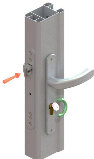
**Etape 6 (Rappel) :** La serrure multifonction dispose d'une ouverture à la clé, sans action sur la poignée, quelle que soit sa configuration
