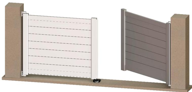
**Etape 2 :** A l'aide d'une clé allen n°5, réglez la position du basculeur de façon à ce que le vantail soit bloqué, puis resserrez
