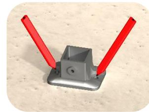
**Etape 9 :** Percez avec un foret Ø12 adapté au support. Insérez les chevilles à l'aide d'un marteau puis retirez les vis + rondelles. Fixez l'embase et insérez les caches vis
