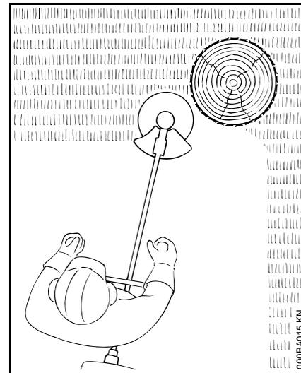
Pour une coupe « en douceur » – pour couper proprement même les bordures irrégulières, autour des arbres, des poteaux etc. – moindre risque d'endommager l'écorce des arbres.
