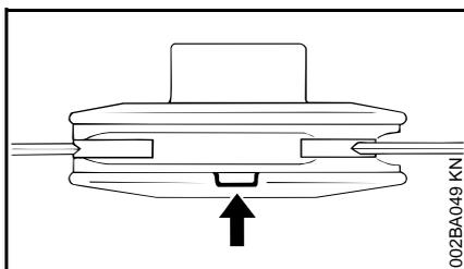
Si, sur la tête faucheuse PolyCut, l'un des témoins d'usure est cassé, du côté inférieur (flèche) : ne plus utiliser cette tête faucheuse, mais la remplacer par
