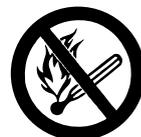
**L'essence est un carburant extrêmement inflammable** – rester à une distance suffisante de toute flamme ou source d'inflammation – ne pas renverser du carburant – ne pas fumer.
