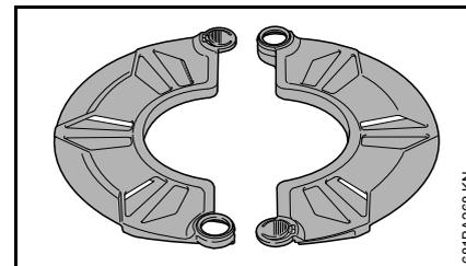
Ce protecteur de transport peut être utilisé pour des couteaux à herbe jusqu'à un diamètre de 230 mm.
