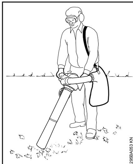
L'aspiro-broyeur est conçu pour être manié à deux mains. L'utilisateur doit tenir la poignée de commande de la main droite et la poignée du carter de la main gauche.
