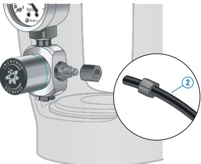
**C** Puis insérez l'extrémité du tuyau de CO<sub>2</sub> sur l'embout du détendeur et revissez l'écrou avec une clé plate de 10.
