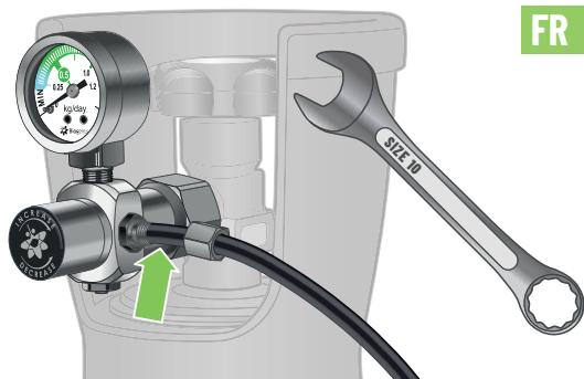
**D** Ouvrez la vanne de la bouteille de CO<sub>2</sub> en tournant dans le sens des aiguilles d'une montre.
