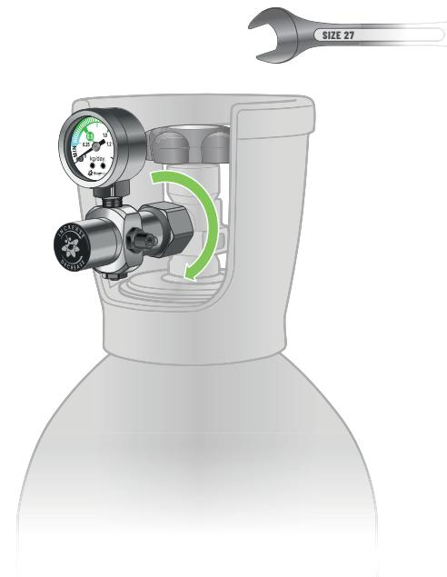
**B** Dévissez l'écrou à la base du détendeur.
