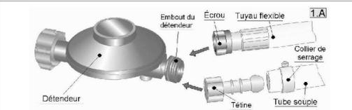
**2) Montage du détendeur sur la bouteille**
