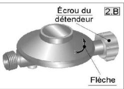
Le serrage doit s'effectuer à la main (Fig. 2C).
