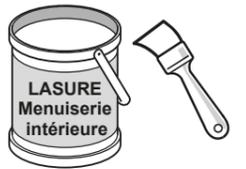
Dès l'enlèvement de son film de protection et AVANT LA POSE, il est OBLIGATOIRE de la PROTÉGER en totalité par un **produit hydrofuge**, spécifique aux menuiseries intérieures en bois replaqué, du type :
