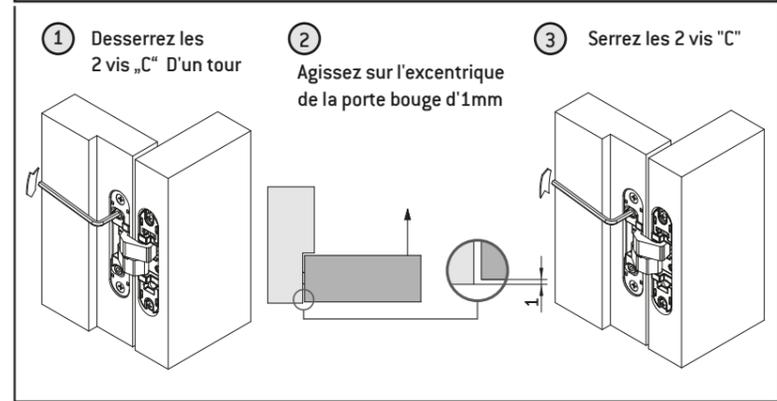
**Réglage hauteur Ajustement lateral**
