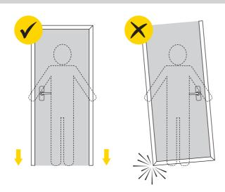
Ne faites pas pivoter la porte sur les coins du bâti pour éviter de l'endommager ou de le dérégler.
