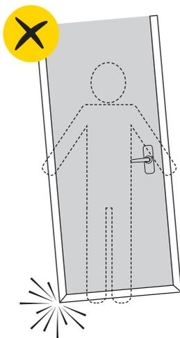
Ne faites pas pivoter la porte sur les coins du bâti pour éviter de l'endommager ou de le dérégler.
