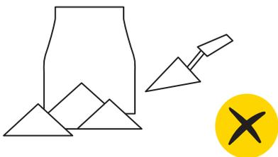
Ne pas utiliser de plâtre, de ciment ou de matériaux corrosifs pour l'installation du bloc.
