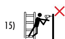
15) Übermäßige seitliche Belastungen vermeiden, z.B. beim Bohren in Mauerwerk und Beton.
