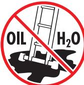
Il est interdit de placer l'échelle sur des surfaces glissantes, p.ex. verglas, surfaces polies ou sur des surfaces solides visiblement salies si des mesures supplémentaires n'ont pas été prises pour empêcher que l'échelle ne dérape et pour garantir une propreté suffisante de l'emplacement.
