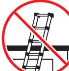
TOUJOURS disposer l'échelle sur l'appui supérieur, jamais par les montants ou échelons qui pourraient subir ainsi des dommages.
