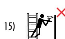
15) Éviter les efforts latéraux trop importants, p.ex. perçage de trous dans les murs et le béton.
