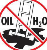
Está prohibido colocar la escalera en superficies resbaladizas, por ejemplo, hielo, superficies pulidas o en superficies sólidas visiblemente sucias si no se han tomado medidas adicionales para evitar que la escalera se deslice y para garantizar suficiente limpieza del sitio.
