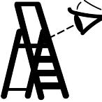
Sichtprüfung der Leiter auf Beschädigung und sichere Benutzung zu Beginn jedes Arbeitstages, an dem die Leiter benutzt werden soll.
