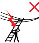
Alle durch elektrische Betriebsmittel im Arbeitsbereich gegebenen Risiken feststellen, z.B. Hochspannungs-Freileitungen oder andere freiliegende elektrische Betriebsmittel.
