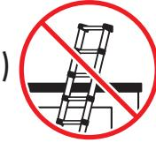
Die Leiter STETS an dem Oberen Träger anstellen, keinesfalls mit den Holmen oder Sprossen, die dadurch beschädigt werden könnten.
