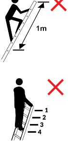
Ne pas utiliser pour surface d'appui des échelons situés dans la limite d'1 mètre à partir du bord supérieur.
