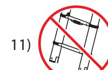
11) Échelles télescopiques 7113-232 et 7113-212 : L'échelle ne doit être utilisée que si la barre transversale est installée.
