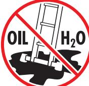
È vietato posizionare la scala su superfici scivolose, ad es. Ghiaccio, superfici lucide o su superfici solide visibilmente sporche se non sono state prese ulteriori misure per impedire che la scala scivoli e garantire sufficiente pulizia del sito.
