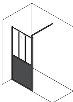
Pour commencer, positionnez le profilé mural sur votre mur à l'emplacement souhaité et repérez les trous en vérifiant l'aplomb à l'aide d'un niveau à bulle.
