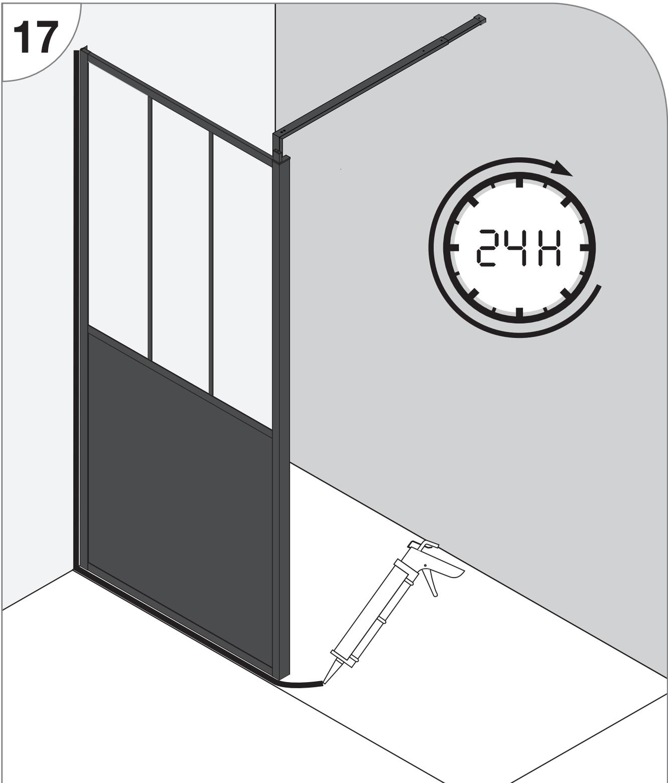
Afin d'assurer une étanchéité totale, nous conseillons de silicuner les jonctions extérieures avec le mur et le sol. Utiliser du silicone sanitaire bactéricide et fongicide afin de garantir sa tenue dans le temps.
