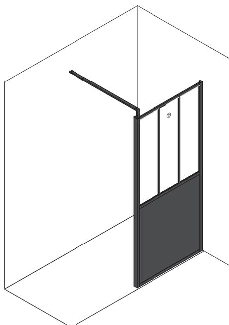
Vous avez la possibilité de réaliser un montage à gauche ou un montage à droite. Nos instructions de montage décrivent uniquement un montage à gauche à partir de l'étape 2. Si vous voulez réaliser un montage à droite, il vous suffit d'inverser le sens.
