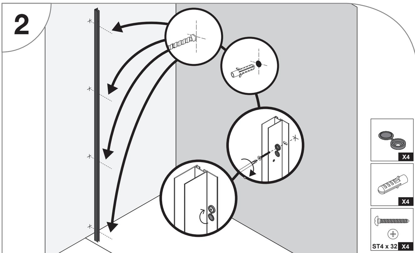
Percez les trous à l'aide d'un forêt adapté à votre mur (non-fourni). Fixez le profilé au mur à l'aide de chevilles et de vis adaptées à votre mur. Sans oublier d'intercaler les cache-vis.
