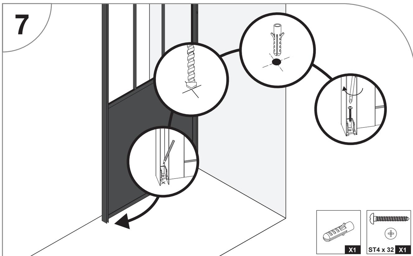
Repérez la position du trou avant de percer à l'aide d'un forêt adapté à votre support (non-fourni).
