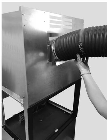
*Fig. 71 - Positionnement du tuyau flexible*
