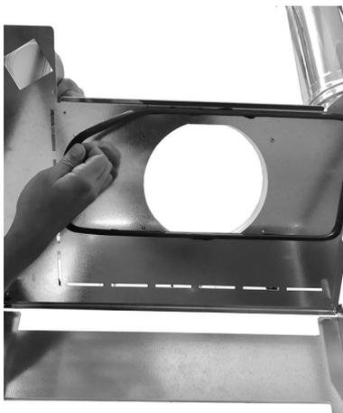
Fig. 58 - Retrait du joint d'étanchéité
