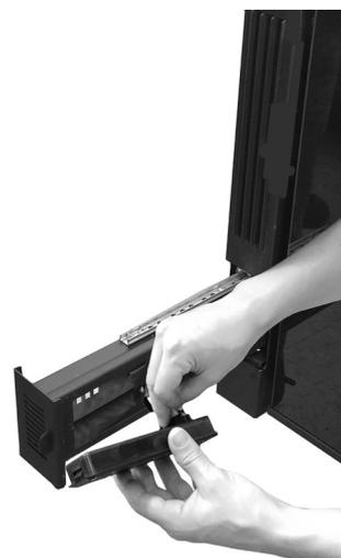
**Fig. 90 - Connecter et repositionner l'écran**
