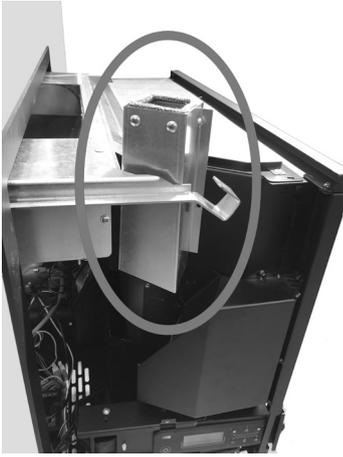
**Fig. 50 - Positionner le déviateur de l'air**
