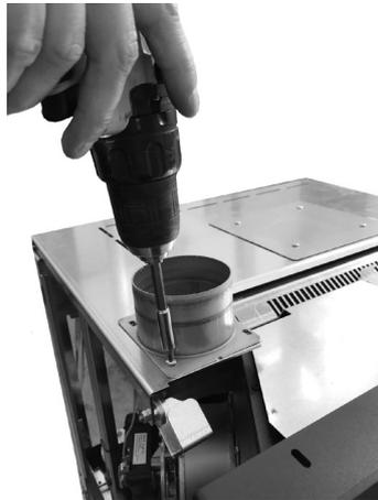
**Fig. 54 - Fixer le raccord**
