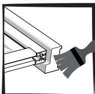
Protéger toutes les surfaces du bloc-porte (huisserie), en contact direct avec le sol et le mur, par un produit bouche-pores.
