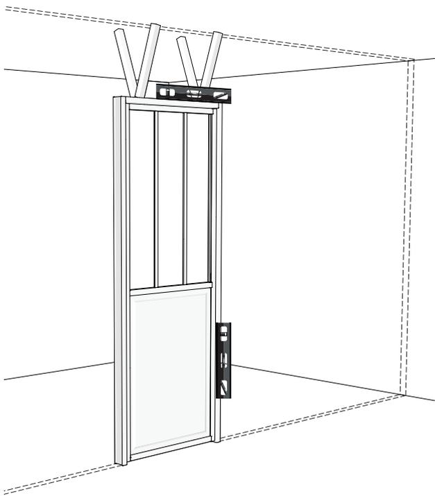
**E** •Fixer le bloc-porte au sol en adaptant le système de fixation (non fourni) au type de sol.
