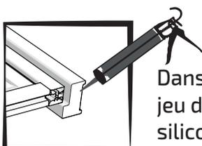
Dans des environnements très humides, il est fortement conseillé de laisser un jeu de 1 mm entre l' huisserie et le sol en isolant les deux montants du sol par du silicone ou de la bande résiliente.
