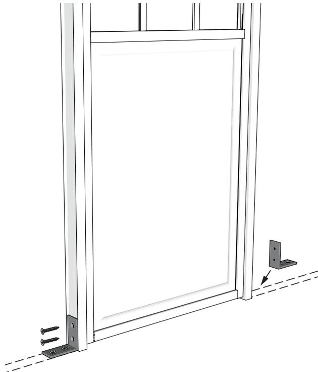
**F** •Poser les carreaux de plâtre et fixer les pattes de scellement (non fournies) dans les huisseries au niveau des charnières et à la jonction de deux plaques de plâtre.
