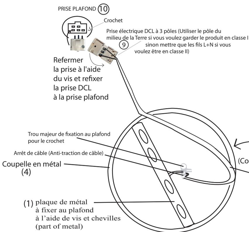
3. Retirer les différents sacs plastiques et retirer le boîtier de connexion en dévissant à l'aide d'un tournevis les vis dans ce boîtier.
