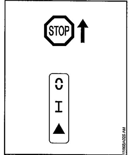
**STOP** ou 0 – pour couper le contact, il faut pousser le levier de commande universel en direction de **STOP** ou 0. Lorsqu'on le relâche, le levier de commande universel revient en position I, sous l'effet de son ressort.
