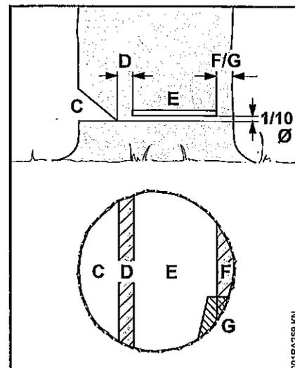
L'entaille d'abattage (C) détermine la direction de chute.
