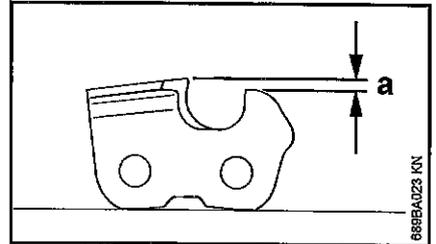
Le limiteur de profondeur détermine la profondeur de pénétration dans le bois et, par conséquent, l'épaisseur des copeaux.
