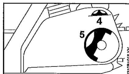
À la mise en place du couvercle de pignon, les dents de la roue dentée de tension et de la rondelle de tension doivent s'engrener ; si nécessaire,
