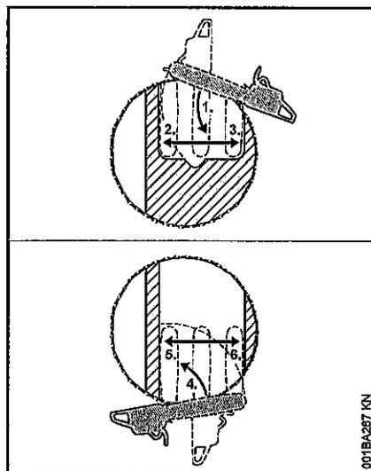
Choisir ce genre de coupe d'abattage lorsque le diamètre du tronc est supérieur à la longueur de coupe de la tronçonneuse.
