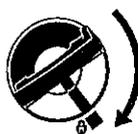
Dans le cas du bouchon de réservoir à ailette rabattable (verrouillage à baïonnette), le présenter correctement, le faire tourner jusqu'en butée et rabattre l'ailette.
