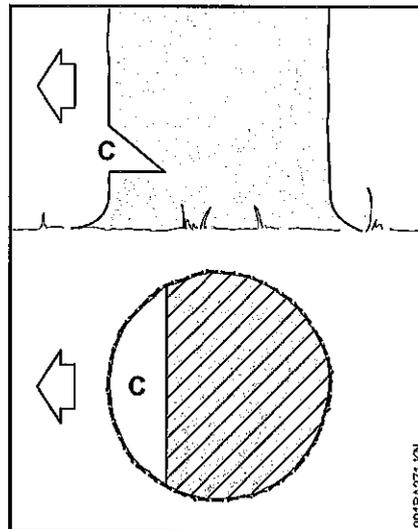
L'entaille d'abattage (C) détermine la direction de chute.
