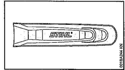
Un protège-chaîne convenant pour le dispositif de coupe respectif est joint à la livraison de la machine.
