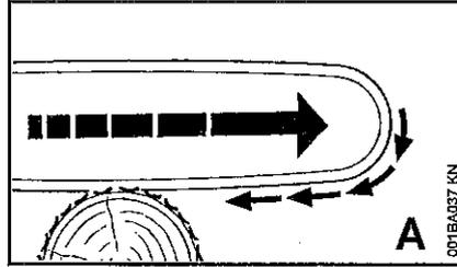
Si lorsqu'on coupe avec le côté inférieur du guide-chaîne – coupe sur le dessus – la chaîne se coince ou touche un corps étranger noyé dans le bois, la tronçonneuse peut être brusquement attirée vers le tronc – **pour éviter ce phénomène, toujours fermement appliquer la griffe contre le bois à couper.**
