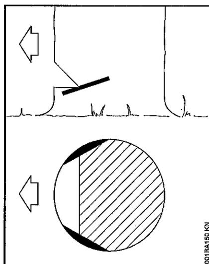
En cas de bois à longues fibres, les entailles dans l'aubier empêchent l'éclatement de l'aubier à l'abattage de l'arbre – exécuter ces entailles des deux côtés du tronc, au niveau de la base de l'entaille d'abattage, sur une largeur correspondant à env. 1/10 du diamètre du tronc – en cas de troncs de très grand diamètre, exécuter des entailles d'une profondeur maximale égale à la largeur du guide-chaîne.
