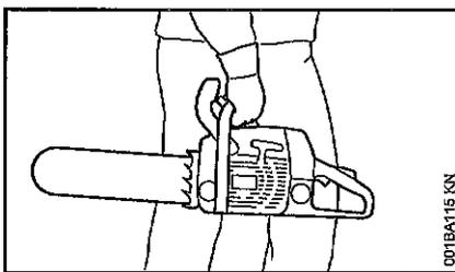
Toujours porter la tronçonneuse seulement par la poignée tubulaire – le silencieux très chaud étant tourné du côté opposé au corps – et le guide-chaîne étant orienté vers l'arrière. Ne pas toucher aux parties très chaudes de la machine, tout spécialement à la surface du silencieux – risque de brûlure !
