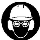
Afin de réduire le risque de blessures des yeux, porter des lunettes de protection couvrant étroitement les yeux, conformément à la norme EN 166, ou une visière protégeant le visage. Veiller à ce que les lunettes de protection et la visière soient parfaitement ajustées.
