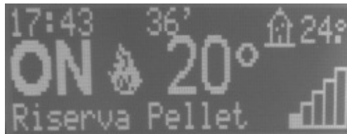
Fig. 15 - Réserve de granulés de bois
