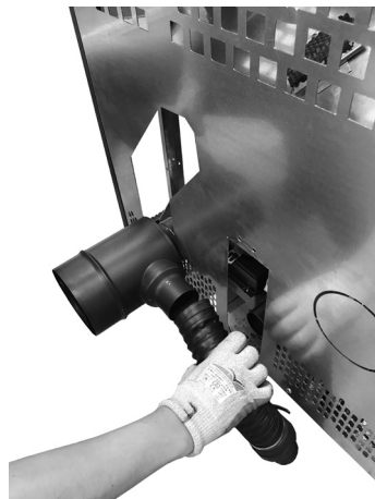
Fig. 54 - Branchement du tuyau flexible
