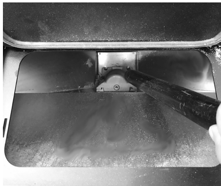
Fig. 25 - Nettoyage réservoir et vis sans fin
