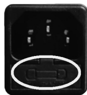
Fig. 87 - Hublot avec les fusibles à enlever
