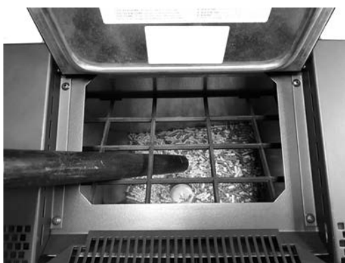
Fig. 29 - Nettoyage réservoir et vis sans fin
