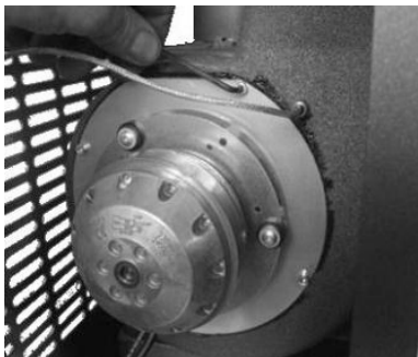
Fig. 59 - Nettoyage de l'aspirateur des fumées: phase 1
