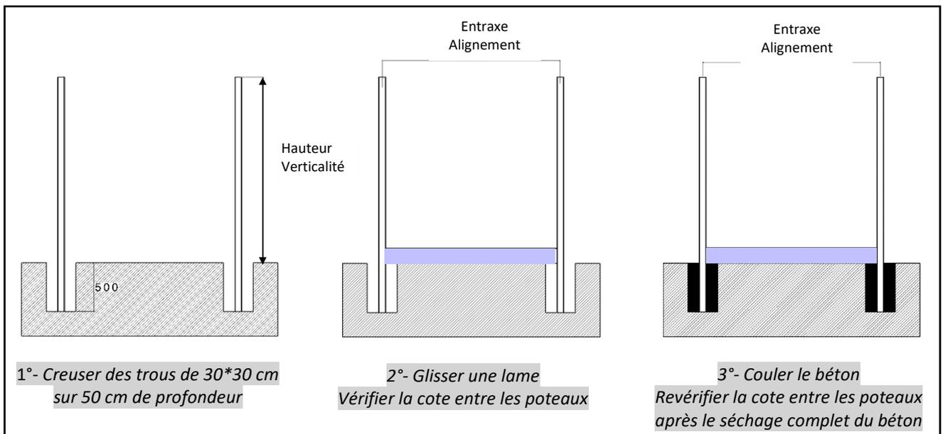
**Note 1 :** nous vous recommandons une pose à l'avancement, c'est-à-dire d'insérer les lames dans les poteaux au fur et à mesure du scellement de ces derniers, tout en assurant une mise à niveau (horizontalité et verticalité) et un calage latéral de l'ensemble à chaque étape.
