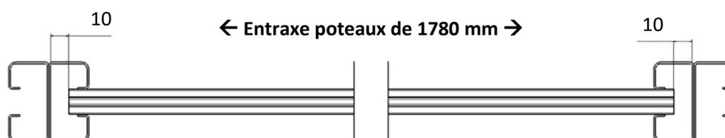
**Contrôlez la verticalité, la hauteur, l'entraxe des poteaux et leur alignement lors de la pose et également après séchage lorsque la fixation se fait par scellement dans le béton.**
