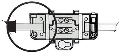
> Effectuer les connexions sur les bornes métalliques du boîtier
