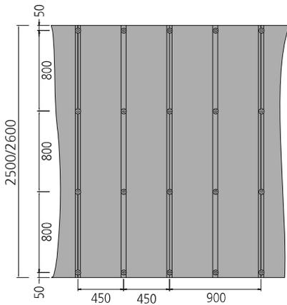
Application : étais espacés de 450 mm pour panneaux de construction à partir de 12,5 mm.
