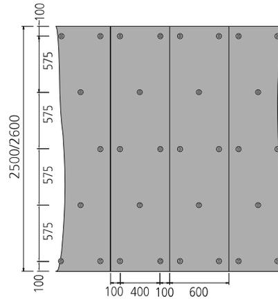
Application par collage sur toute la surface et plots de mortier à partir de 20 mm.
