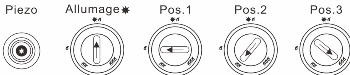
Le chauffage peut être réglé sur trois niveaux : 1. Minimum 2. Medium 3. Maximum
