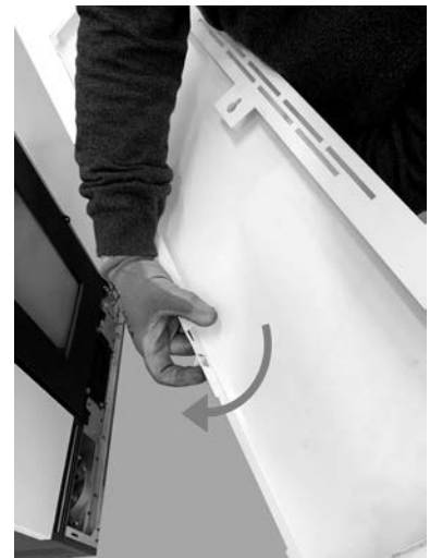
Fig. 47 - Plier les languettes
