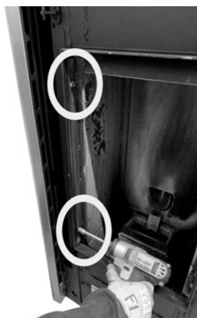
Fig. 105 - Ôter les vis hexagonales
