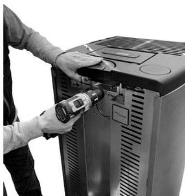
Fig. 58 - Retirer le bouchon (Atena 3 Plus 12/14 - Duke At)
