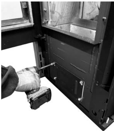
Fig. 112 - Retirer le bouchon
