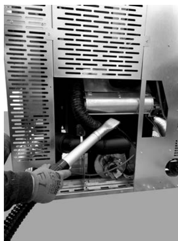
Fig. 117 - Nettoyage de le ventilateur ambiant (Mithos 3 Plus 12/14)
