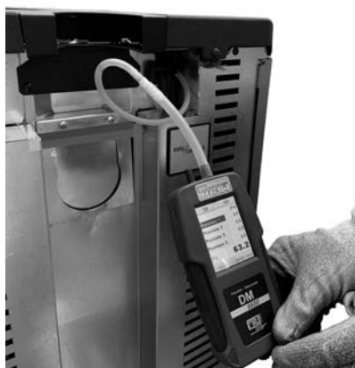
Fig. 97 - Connexion du pressostat numérique (Atena³ Plus12/14 - Duke 12/14 At - Saba 12/14)
