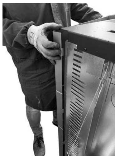
Fig. 36 - Décrocher le flanc
