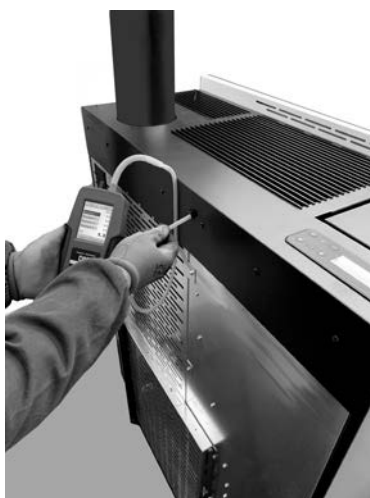
Fig. 98 - Connexion du pressostat numérique (Mithos 3 Plus12/14)
