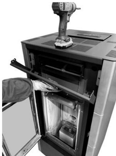
Fig. 33 - Décrocher le panneau supérieur.
