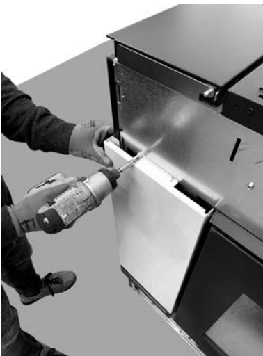
Fig. 45 - Fixer les panneaux latéraux
