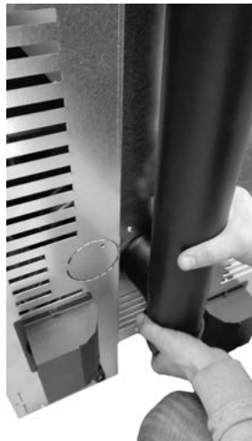
Fig. 64 - Raccorder le tuyau d.80 mm
