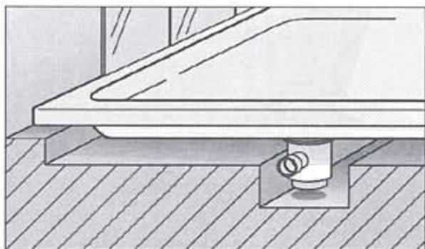
*Pose au sol (bord du receveur au dessus du sol) :*
