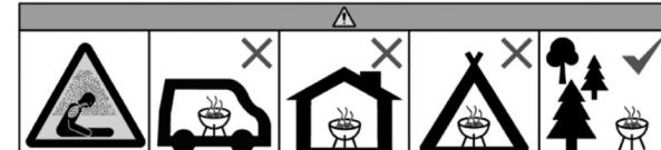
Ne pas faire fonctionner dans des locaux fermés et/ou habitables, par exemple des bâtiments, tentes, caravanes, mobile-homes ou bateaux. Danger d'empoisonnement au monoxyde de carbone.
