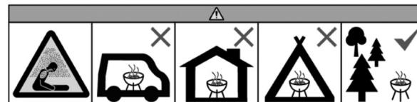
Ne üzemeltesse zárt és/vagy lakható helyiségekben, pl. épületben, sátorban, lakókocsiban, mobilházban, hajón. Szén-monoxid-mérgezés okozta életveszély áll fenn.
