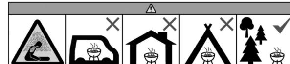
Η λειτουργία δεν επιτρέπεται σε κλειστούς ή/και κατοικήσιμους χώρους, π.χ. κτίρια, σκηνές, τροχόσπιτα, αυτοκινούμενα, σκάφη. Υπάρχει κίνδυνος θανάτου λόγω δηλητηρίασης από μονοξείδιο του άνθρακα.
