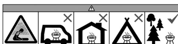
Non utilizzare in locali chiusi e/o abitabili, ad es. edifici, tende, roulotte, camper, barche. Pericolo di morte causata da intossicazione da monossido di carbonio.
