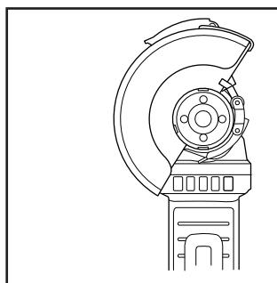
Utilizați capacul de protecție la polizare pentru operația de polizare.
