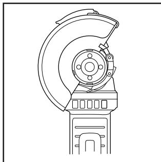
Для шліфування використовуйте захисну кришку для шліфування.
