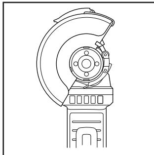
Χρησιμοποιήστε το προστατευτικό κάλυμμα τροχίσματος για εργασίες τροχίσματος.
