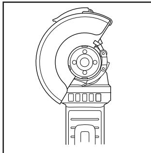
Utilize a cobertura de proteção da rebarbadora para a operação de esmerilagem.
