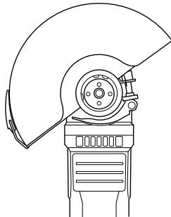
Χρησιμοποιήστε το προστατευτικό κάλυμμα τροχίσματος για εργασίες τροχίσματος.
