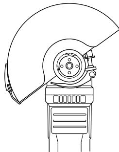
Для шліфування використовуйте захисну кришку для шліфування.
