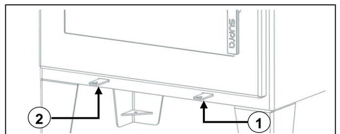
L'intensité du feu se règle à l'aide de la commande 1. La commande 2 ne doit jamais être complètement fermée, car cela pourrait entraîner un encrassement de la vitre.
