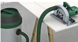
Découpez la plaque à l'aide d'une scie circulaire (lame de carbure) avec aspirateur ou à défaut du cutter **fermacell** ou d'une scie égoïne.
