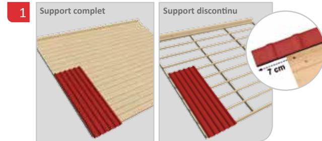
Commencer l'installation des plaques en laissant un cordeau de 7 cm au dessus de la gouttière. L'installation peut être réalisée sur une surface pleine (recommandée) ou sur liteaux.
