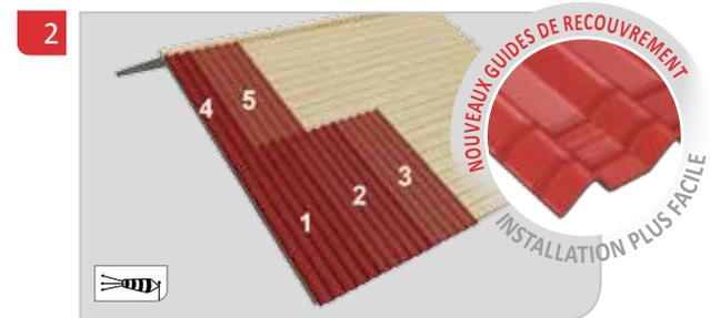
installez les plaques dans le sens contraire du vent. Étalez les rangés en commençant la seconde rangée avec une demie plaque. assurez facilement l'étanchéité en alignant les deux guides de recouvrement.
