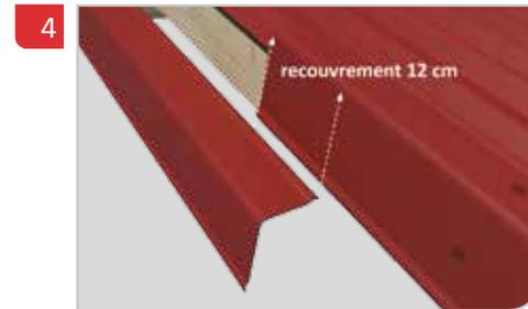
L'esthétisme et le protection contre le vent peuvent être optimisés en utilisant les accessoires de rives qui se fixent sur le côté de la toiture puis sur le sommet des ondes.
