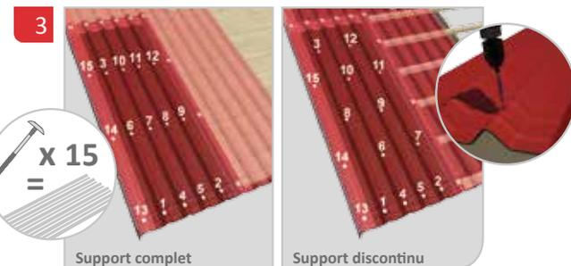
15 fixations minimums doivent être utilisées par plaque. La fixation se fait toujours sur le sommet de l'onde en respectant le bon ordre de pose et toujours entre les deux guides de recouvrement. Attendez de fixer la dernière onde avant de recouvrir celle-ci par la plaque suivante.
