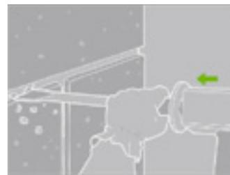
***Les joints de ciment qui résistent (appareillage de blocs béton) peuvent être dégarnis à la meuleuse équipée d'un disque à déjoindre.***
