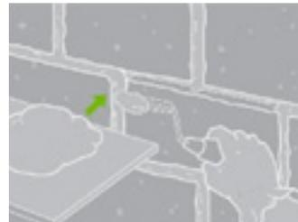
*Sur un mur en briques, en pierres de taille ou en parpaings décoratifs, l'utilisation d'un fer court facilite le remplissage et évite de salir les blocs adjacents. Si vous ne possédez que des fers longs, recoupez-en un de moitié pour qu'il fasse environ 8 cm. Arrondissez l'extrémité à la lime et ébavurez la coupe avant l'emploi.*
