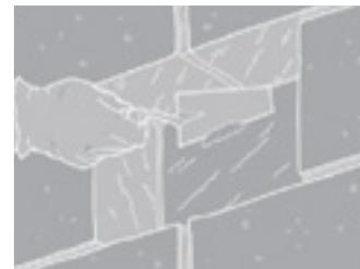
***Remplacez les blocs en réglant l'espacement des joints à l'aide de petits éclats de brique ou de pierre. Enfoncez suffisamment les éclats de manière à les noyer dans le mortier.***
